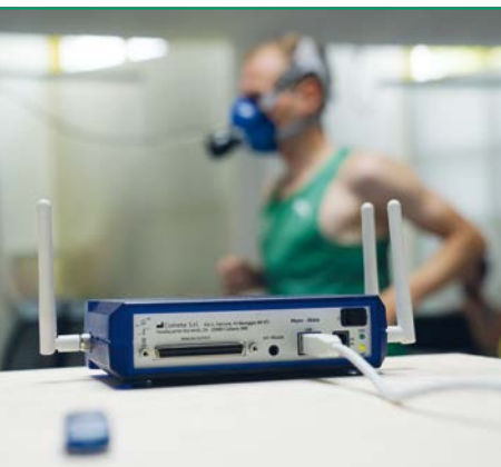
■ Abb. 2: Die Muskelaktivität wird kabellos während des Test neuer Laufschuhe erfasst (Foto: Michael Frisch).
