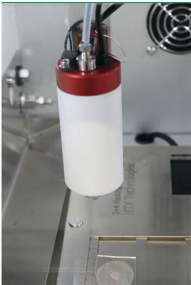
■ Abb. 2: Der Sprühkopf in der Kammer nähert sich der Probe, um die MALDI-Matrix aufzusprühen (Foto: Christian Wiffler).
