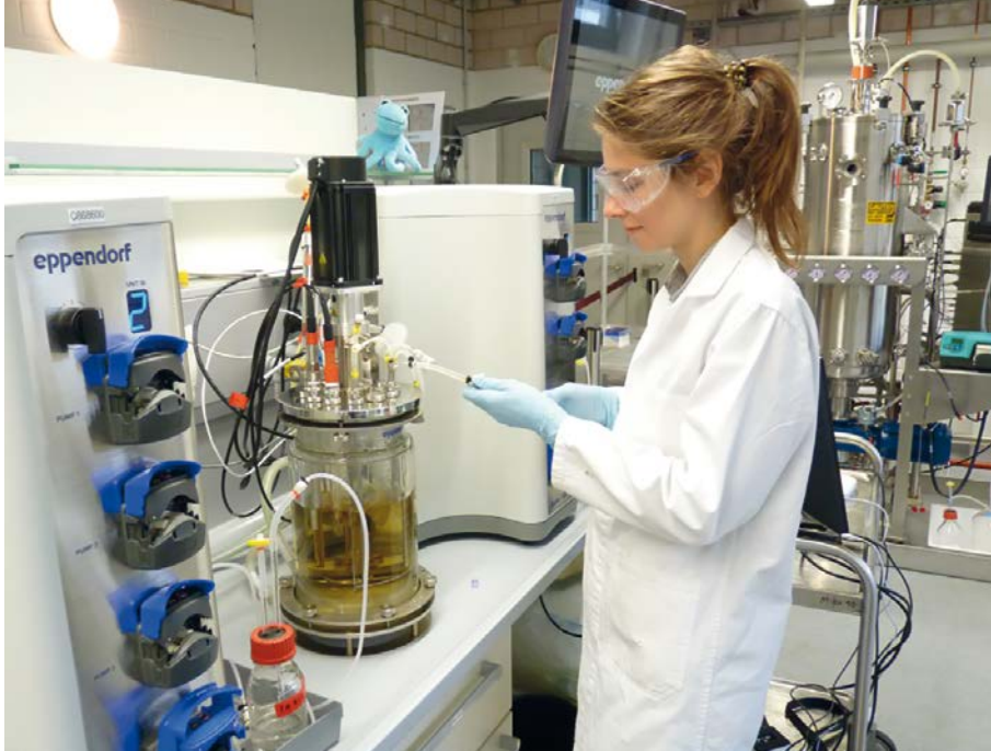
■ Abb. 2: Sophia Tessaro M.Sc., wissenschaftliche Mitarbeiterin am Lehrstuhl für Mikrobiologie der Universität Bayreuth, beim Aufbau eines Fermentationssystems zur automatischen Massenkultivierung von Magnetbakterien (Foto: René Uebe).
