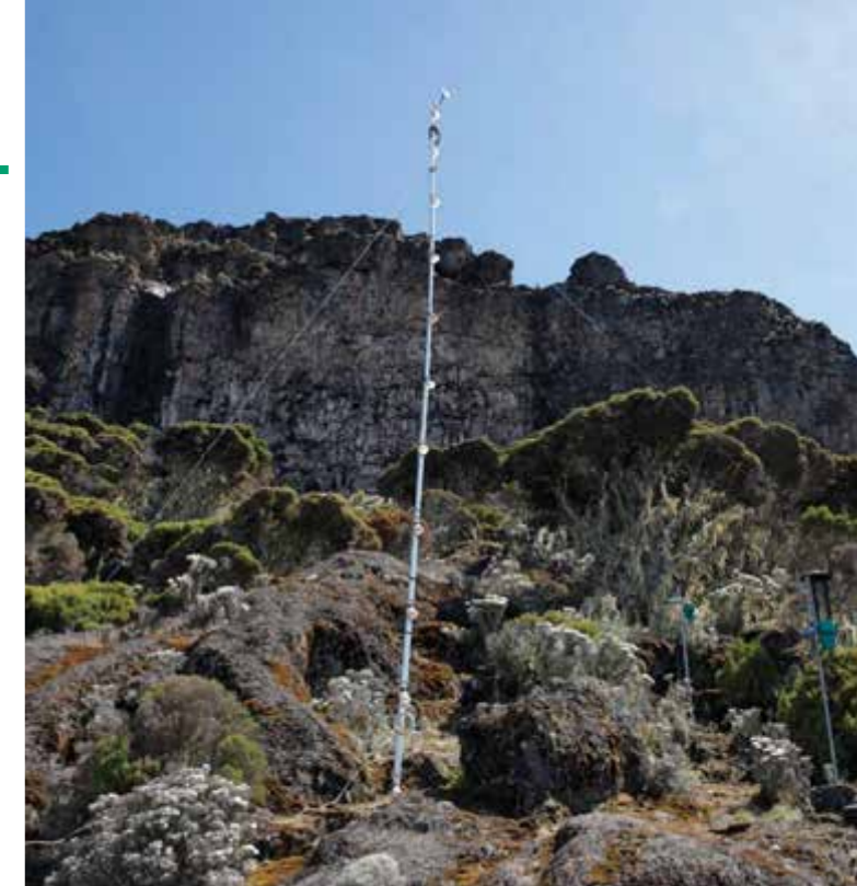
Diese Nebelfänger werden am Kilimandscharo eingesetzt. Foto: Andreas Hemp
