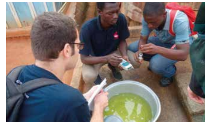
Trinkwasseranalyse mit Hilfe moderner Technik: Erst nachdem der pH-Wert des Wassers stimmt, wird der Brunnen wieder verwendet.
