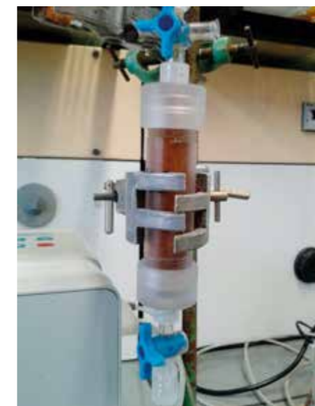
In Rahmen der Laborexperimente werden Säulen mit Schwertmannit gefüllt. Diese werden kontinuierlich mit einer Lösung mit Selen gespült, so dass es zu einer Reaktion kommt. Das Ziel ist dabei, die Effizienz der Selenentfernung in Filterbetten zu bestimmen. Foto: Bouchra Marouane
